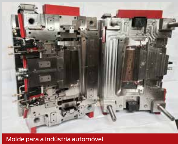
Stackmolde 2K (injecção de 2 materiais)
